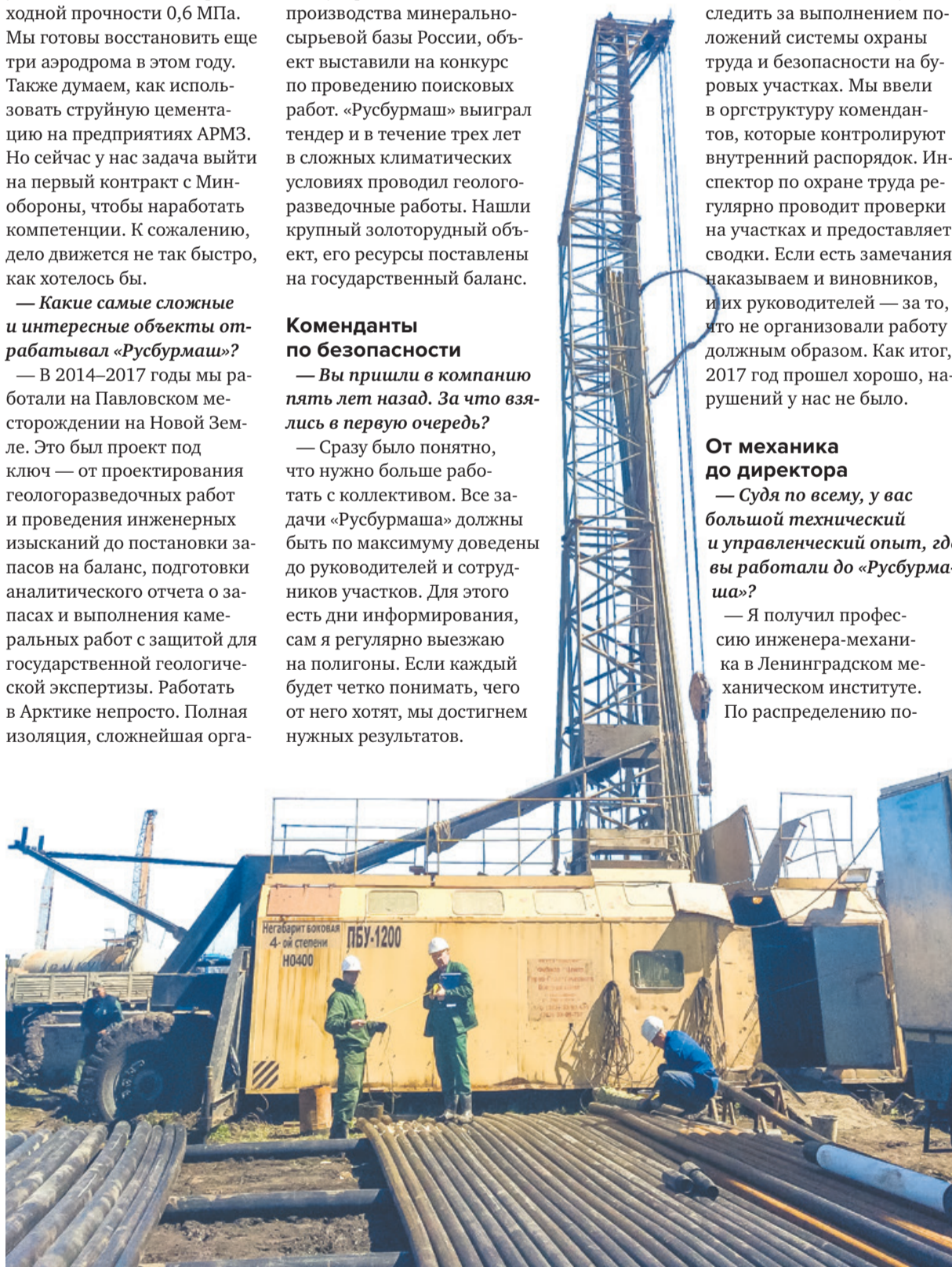
▼ Буровая установка ПБУ-1200 для сооружения скважин
